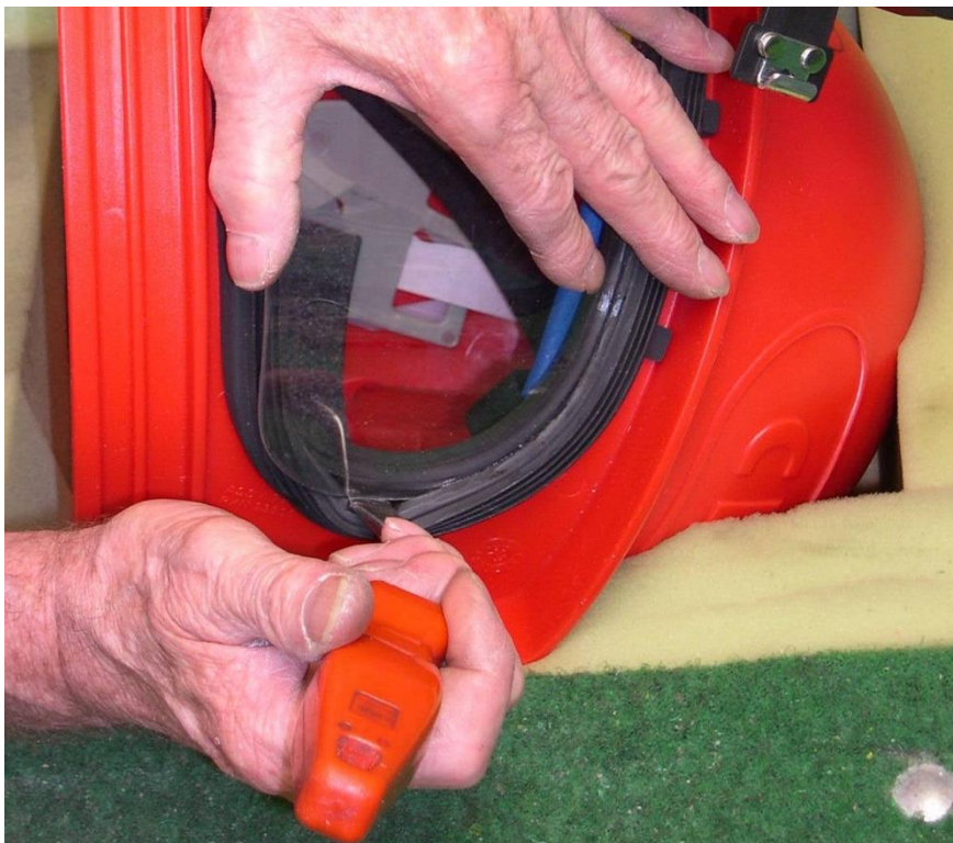
Bild 3: Montage Innenscheibe mit Hilfe des Montagewerkzeuges
